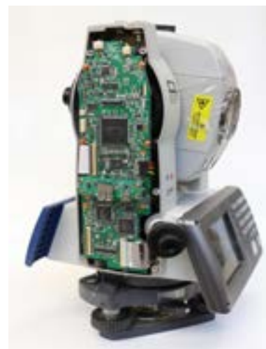
Lentille de l'objectif brisée, plaquette de circuit endommagées et toujours réparable !!!
